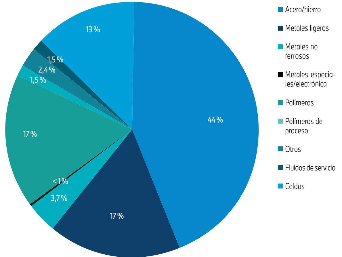
Fig. 2: Porcentaje de materiales que componen el BMW iX2 xDrive30 al inicio de la producción. Los valores indicados pueden presentar diferencias de redondeo.
