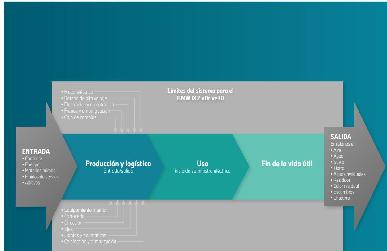
Fig. 1: Límites del sistema para el ACV del BMW iX2 xDrive30
