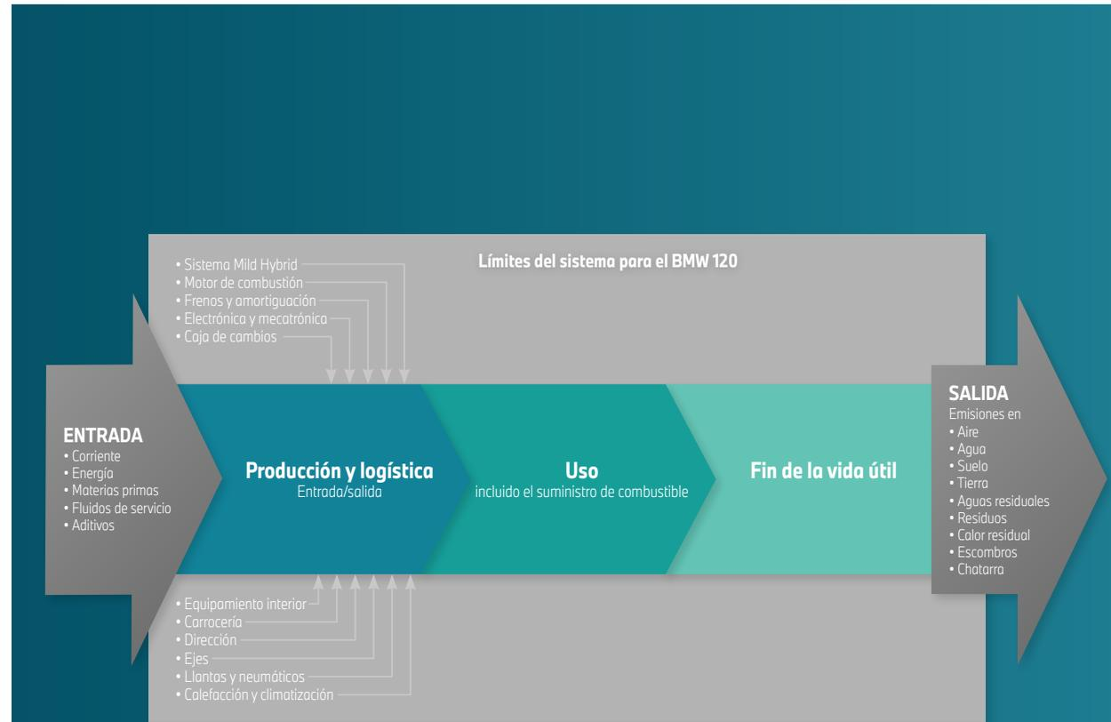
Fig. 1: Límites del sistema para el ACV del BMW 120
